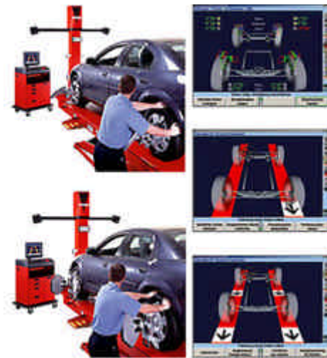
Reflektoren am Fahrzeug anbringen – Felgenkompensation durchführen -nach
