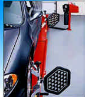
Die Kamera nimmt von den Radreflektoren ein permanentes 360° Messfeld auf.
