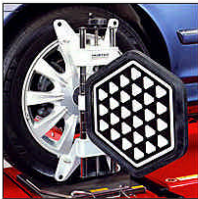
Robuste und stoßsichere Reflektoren, die ohne empfindliche Elektronik auskommen.
